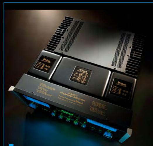
Wyeksponowane na wierzchu (w ekranach) autoformery to znak rozpoznawczy wzmacniaczy tej marki. Pośrodku transformator zasilający. Piękny przykład separacji zasilania od obwodów audio.
