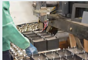
Smoła wlewana do aluminiowych obudów transformatorów redukuje szkodliwe wibracje
